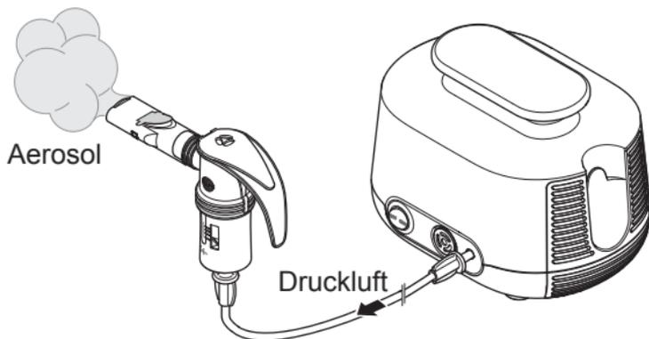
Der Kompressor versorgt den Vernebler mit Druckluft.
