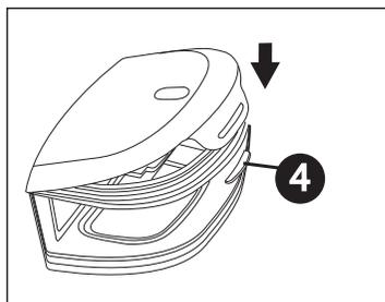
4. Schieben Sie den Wassertank des Luftbefeuchters zurück in das Gerät, indem Sie die Schienen auf der Unterseite der Wassertankbasis zur richtigen Ausrichtung und Verbindung verwenden. Stellen Sie vor dem Fortfahren sicher, dass er eingerastet ist.
