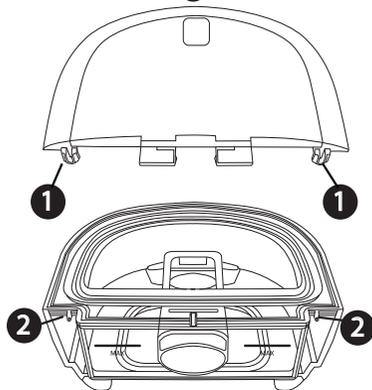
3. Drücken Sie den Deckel nach unten **3** bis dieser sicher über der vorderen Lasche **4** an der Vorderseite der Wassertankbasis einrastet.
