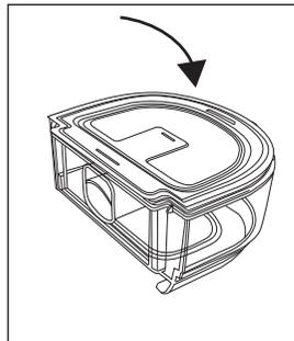
8. Füllen Sie den Wassertank des Luftbefeuchters vor dem Wiedereinsetzen höchstens bis zur maximalen Füllhöhe mit destilliertem Wasser.
